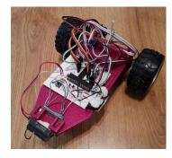
Slika 5: Končna izvedba mobilnega robota.
