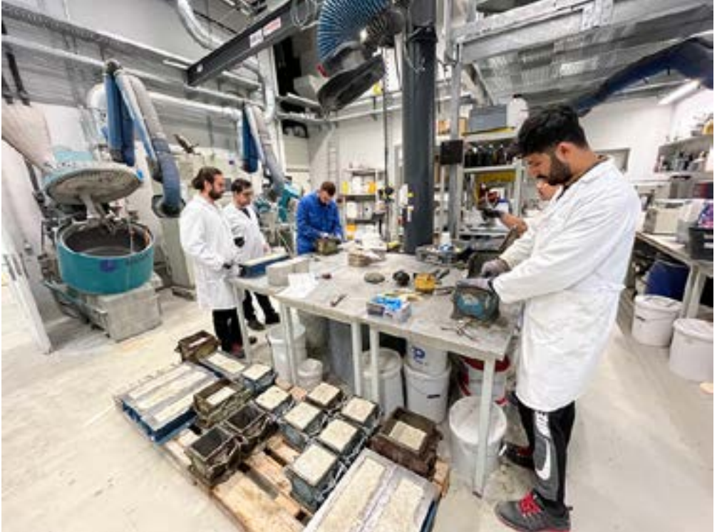
Ulivanje vzorcev betona iz recikliranih agregatov v laboratoriju TU Wien Casting Recycled Aggregate Concrete specimens in the lab of the TU Wien
