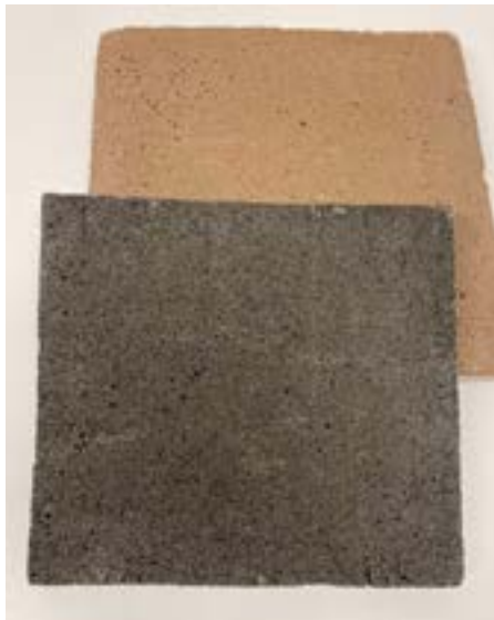
Penjeni alkalijsko aktivirani paneli (žlindra, pepel) Foamed alkali activated panels (slag, ash)
